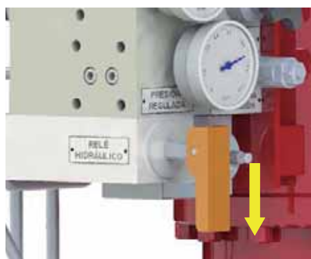
El gatillo cae y se posiciona de forma vertical
