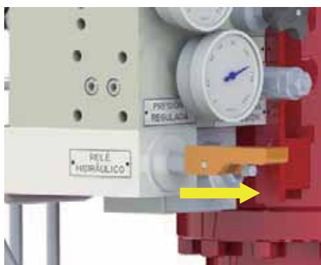
La presión efectuada por la bomba desplaza el vástago hacia fuera del relé
