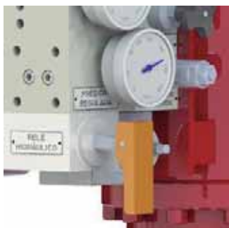
Relé hidráulico en operación
